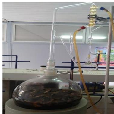
Figure 5: Montage d'hydrodistillation de type Clevenger
