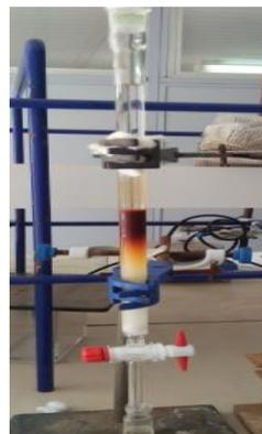
Figure 6: Isolement de l'oxyde de carline par colonne
