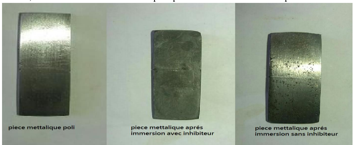
Figure II.1 : Pièces métalliques avant et après immersion.
