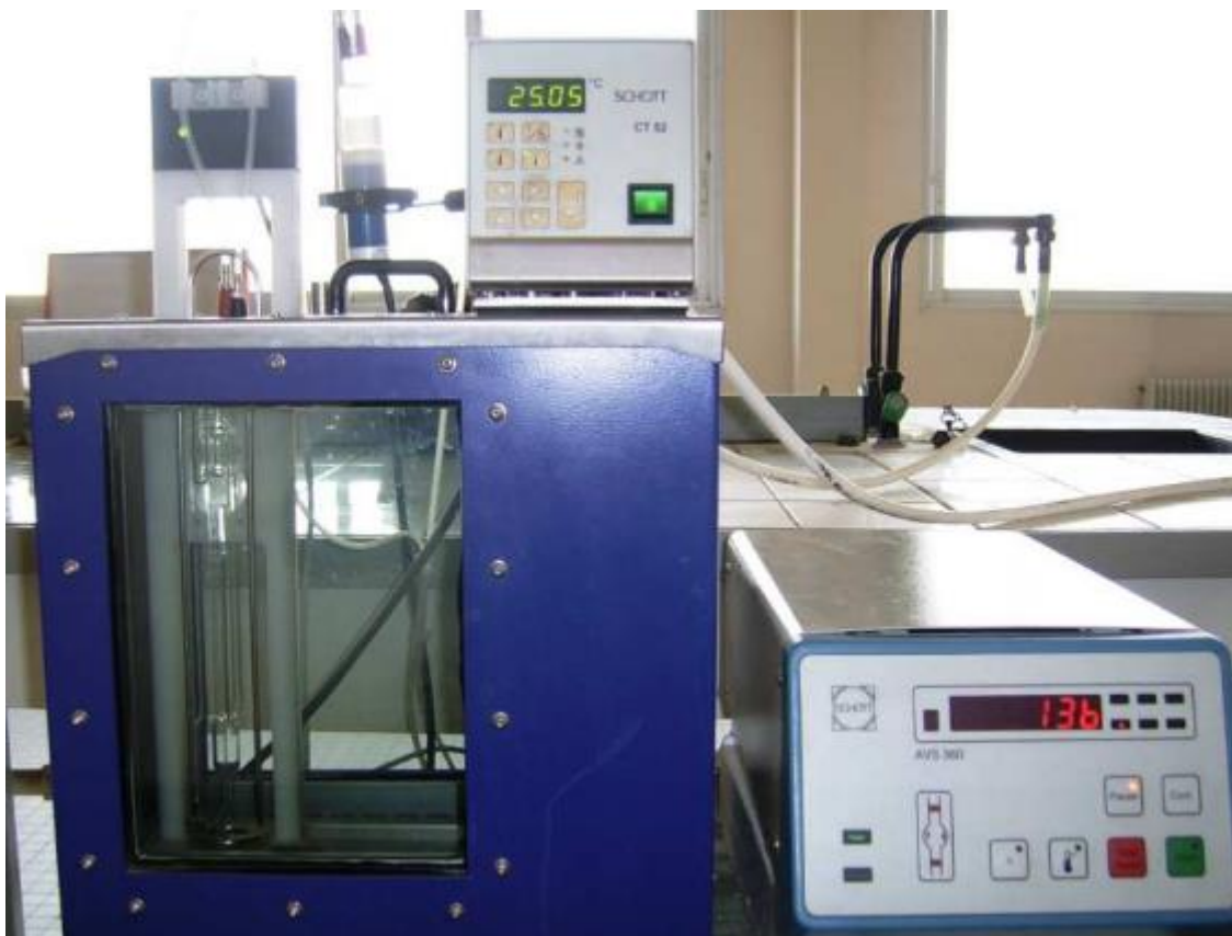
Figure II.2 : Viscosimètre à capillaire type Ubbelhode
