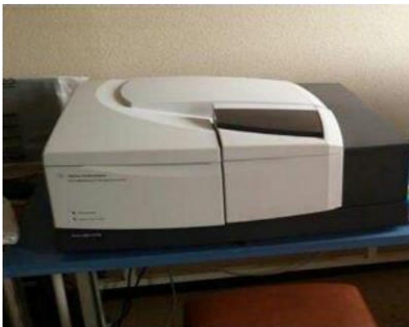
Figure II.5 : Spectrophotomètre Infra-Rouge à transformée de fourrier (FTIR) de type Agilent Technologies Cary 600
