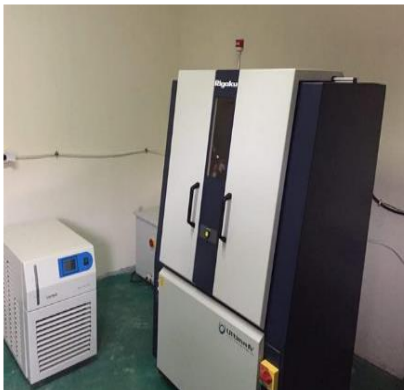
Figure II.8 : Diffractomètre de rayon X Rigaku
