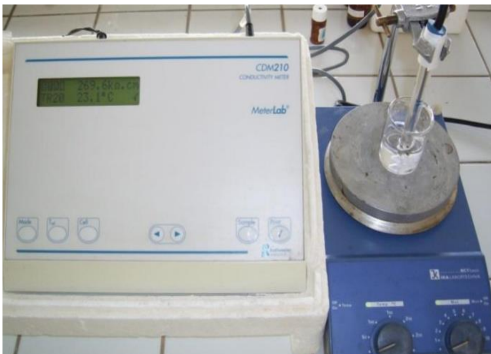
Figure II.4 : Conductimètre utilisé avec sa cellule électrolytique
