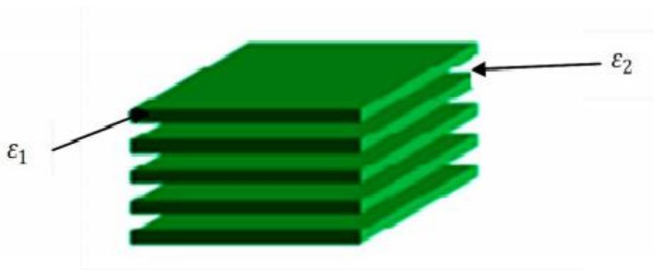
**La figure (I-4) :** Schéma d'un cristal photonique 1D [15]
