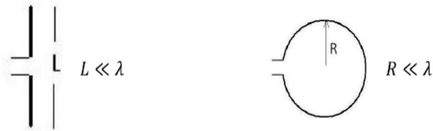
Figure II. 5: Exemples d'antennes électriquement petites, petit dipôle (gauche) et petite boucle (droite)
