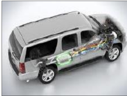
Figure I.6 : Chevrolet Suburban équipé d'un GTE [18].
