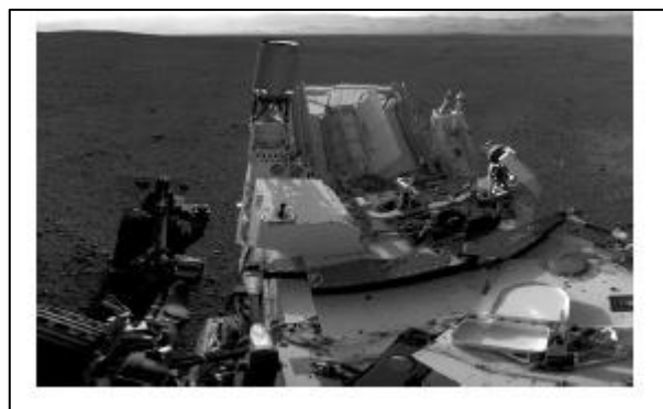
Figure I.3: RTG du rover Curiosity pour mission sur Mars [14].
