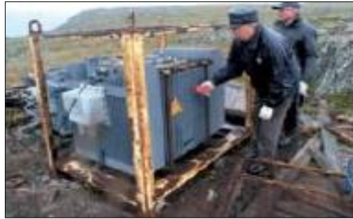
Figure I.4 : Générateur thermoélectrique à Radioisotope pour application terrestre [15].
