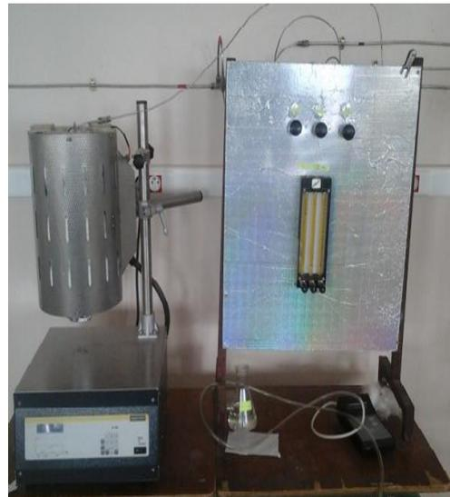
**Figure II-3** : Dispositif expérimental pour les traitements thermiques
