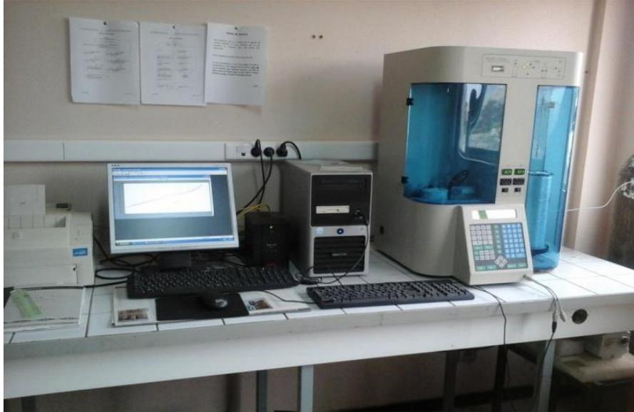
Figure II-4 : appareil d'adsorption/désorption d'azote
