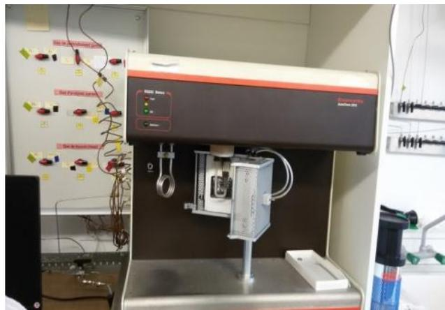
**Figure II-8** : dispositif de Réduction en Température Programmée
