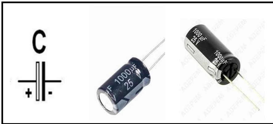
Figure II-4: Symbole et photo d'un condensateur électrolytique
