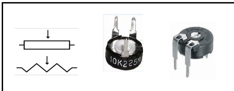
Figure II-1 : Symbole et photo d'une résistance variable
