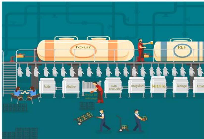
Figure 3.32 : Ligne de production avec nitrile pour les gants infirmier
