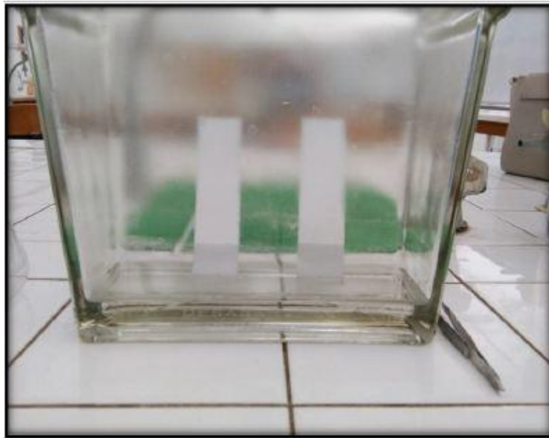
Photo IV.06 : Cuve et plaques CCM. (Photo originale ,2019).
