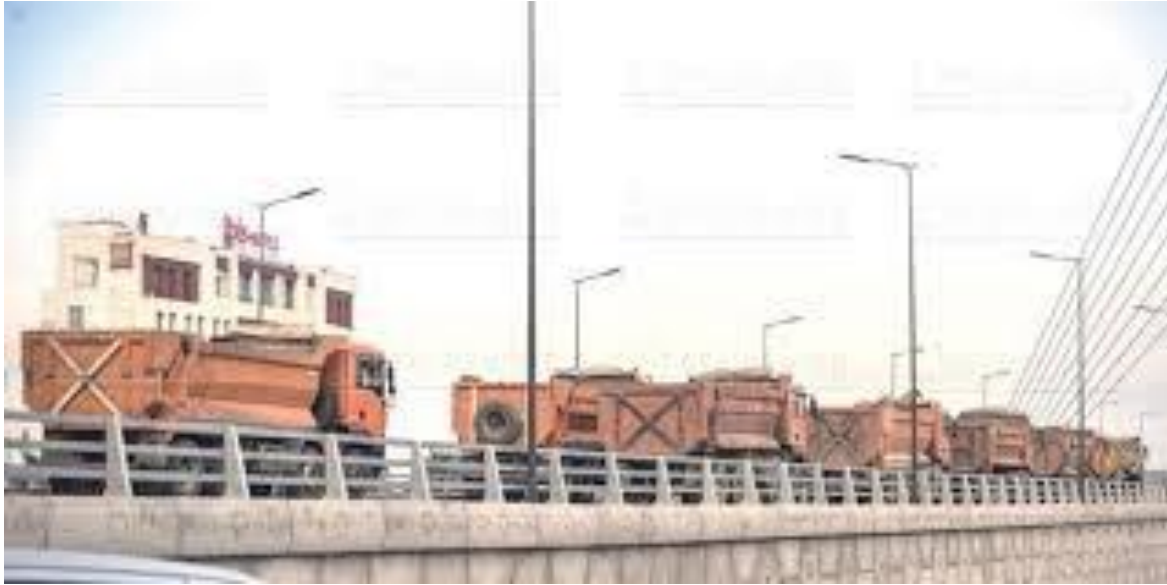
Figure 30:essai de chargement avec camion lourds
