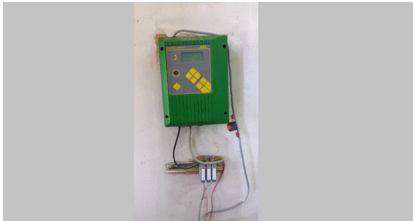
Figure V.4 Station automatisée de mesure des données pluviométriques au pas de 15 min
