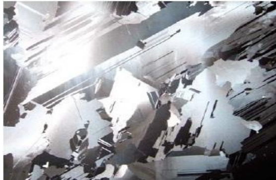
Figure II. 9 : Photo d'un substrat de silicium multi-cristallin (échelle : 10×10 cm 2 )
