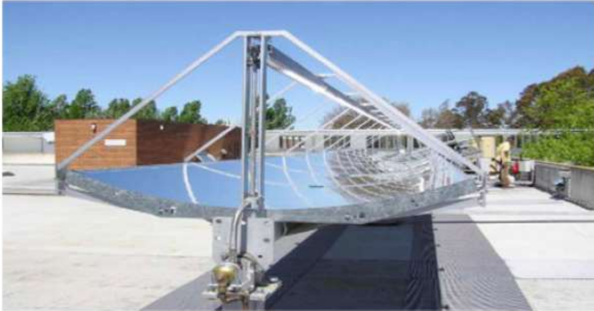
Figure. 2.18. Prototype concentrateur CPVT type ANU [58].
