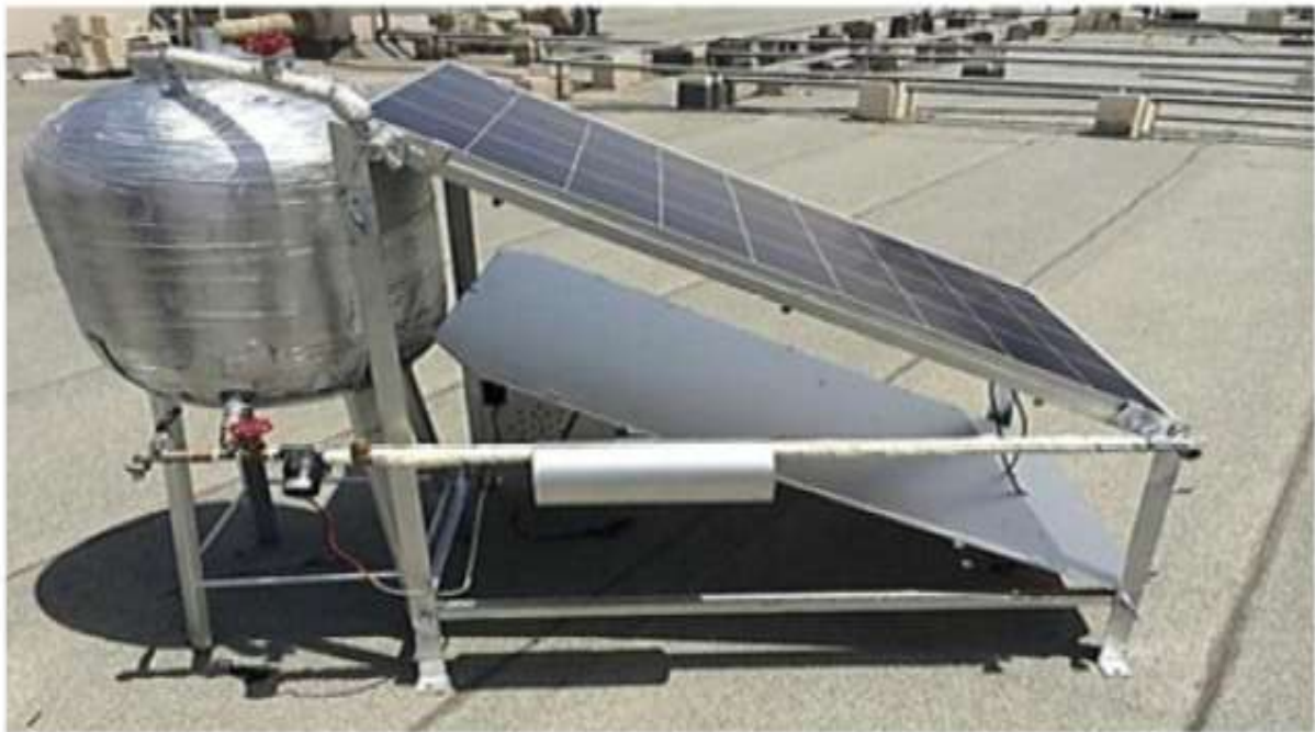
Figure. 2.7. Photo du système PVT à eau [44].
