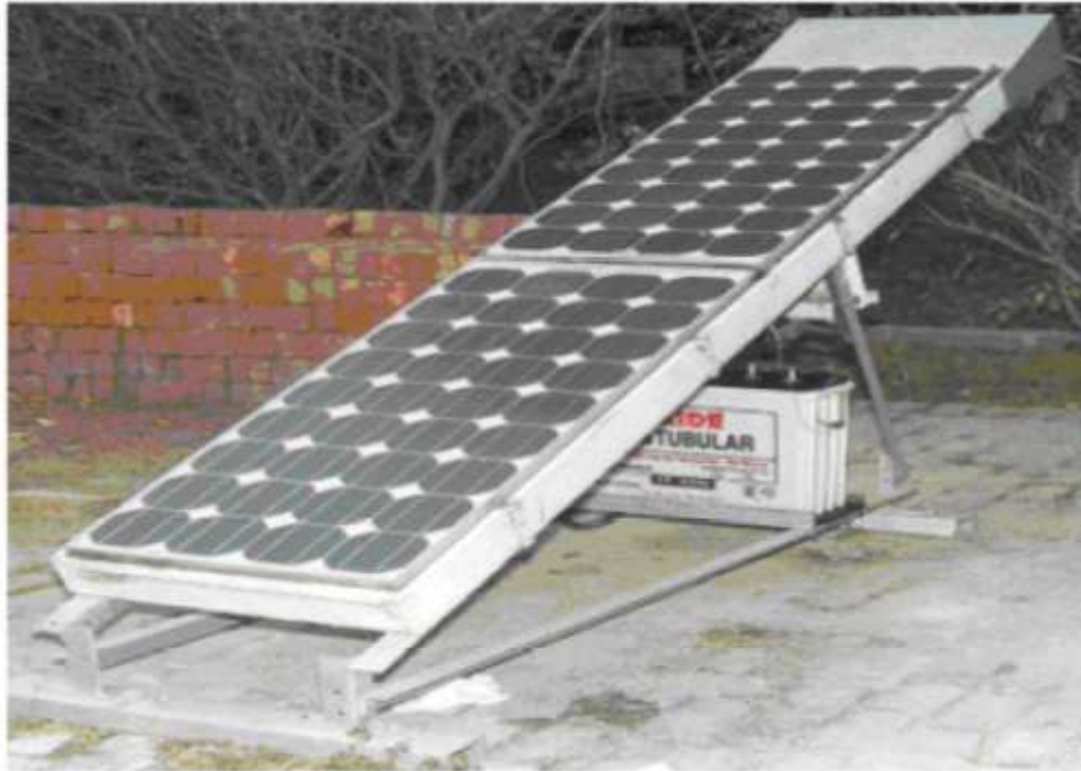
Figure. 2.9. Photographie de l'installation expérimentale d'un collecteur d'air hybride PV / T [49].
