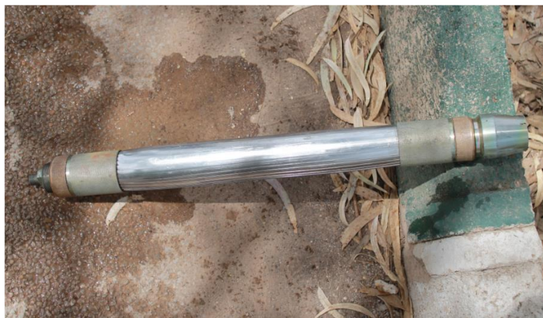
Figure 3-17 Sonde pressiométrique tri cellulaire
