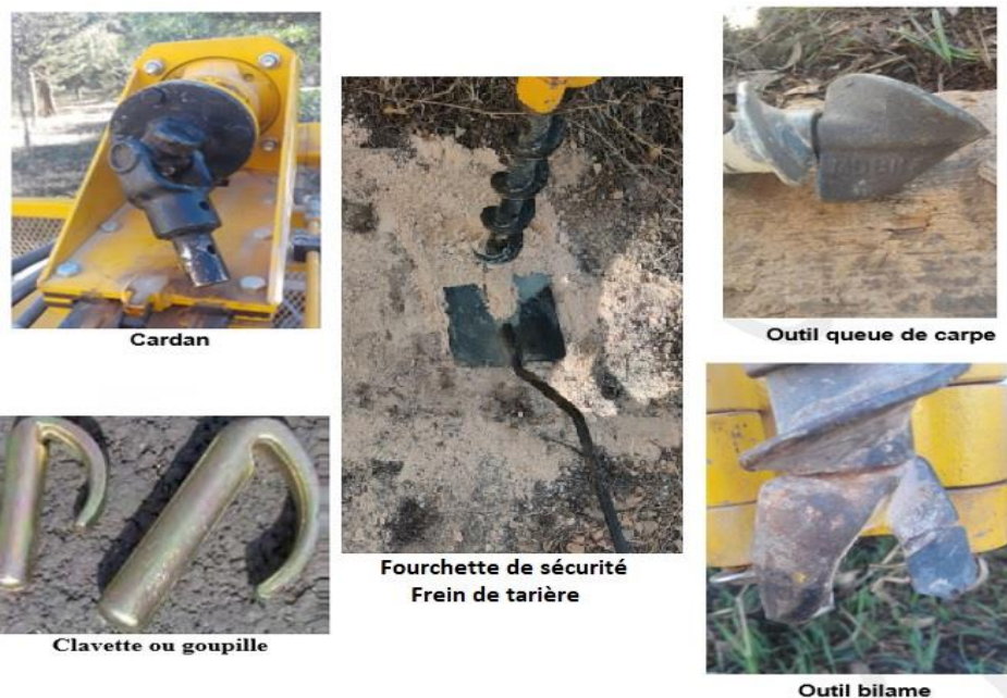
Figure 3-12 Les principaux outils utilisés dans le forage à la tarière hélicoïdale continue.
