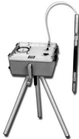
Figure 1-8 Le pressiomètre à cône, Pencil (Farid et al, 2013).
