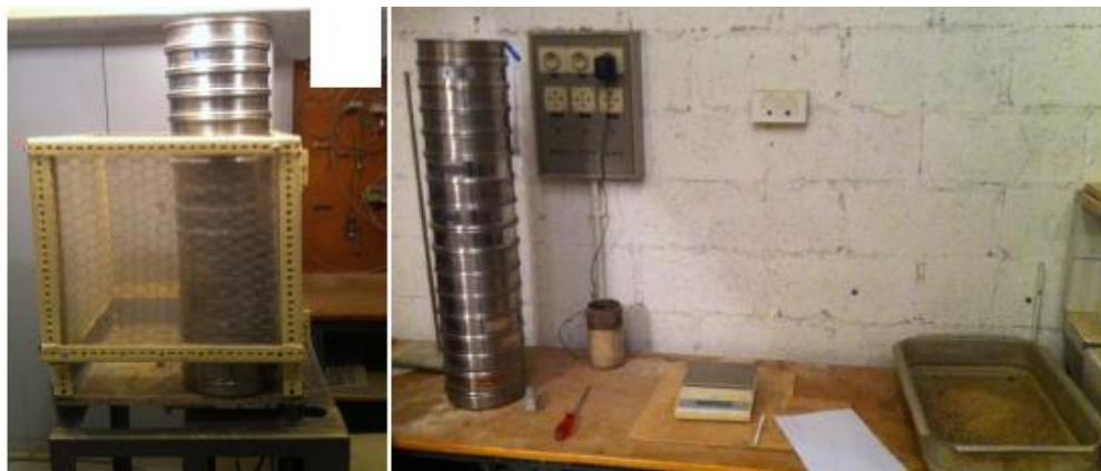
Figure 3-5 Dispositif d'essai granulométrie par tamisage
