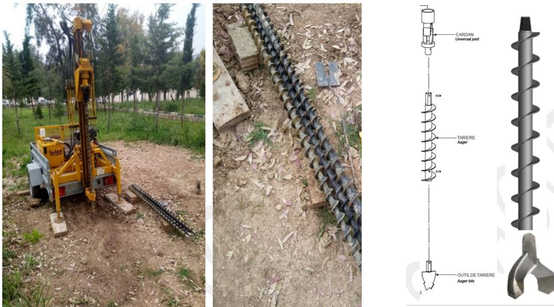
Figure 3-11 Forage à la tarière mécanique hélicoïdale continue.
