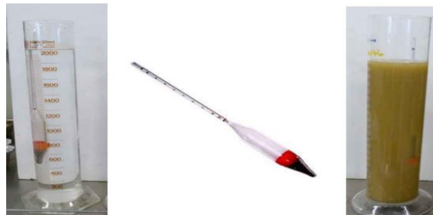
Figure 3-6 Dispositif de l'essai granulométrique par sédimentométrie
