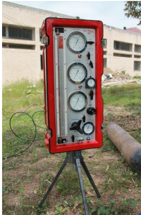
Figure 3-15 Le contrôleur pression-volume CPV
