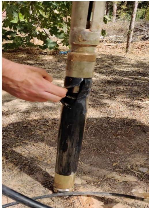
3-32 Membrane éclatée après augmentation brusque de la pression
