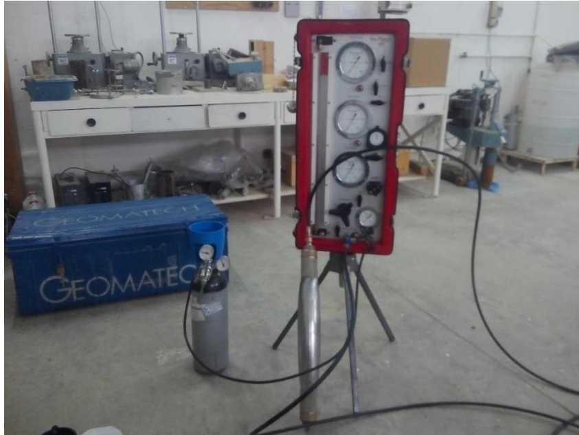
Figure 3-21 Repérage de la sonde et du conditionneur de pression lors de l'essai de résistance propre de la membrane.
