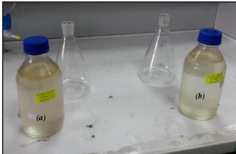
Fig.47: Les eaux de l'unité de déshuilage Centre: (a) eau prélevés à l'entrée de la station, (b): eau prélever à la sortie de la station.
