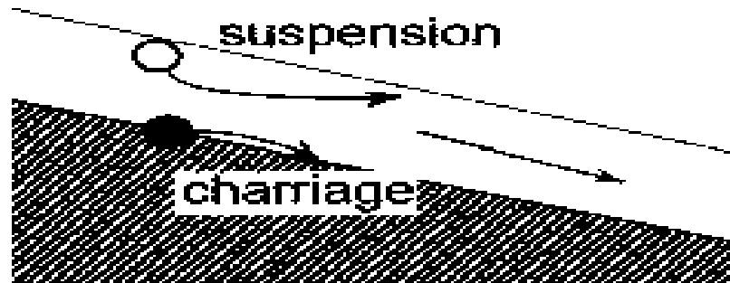
Figure I.1 transport de matériaux en suspension et en charriage
