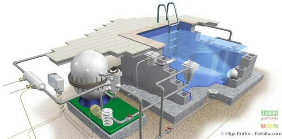
**Figure 165:** fonctionnement d'une filtration classique (vue 3d)
