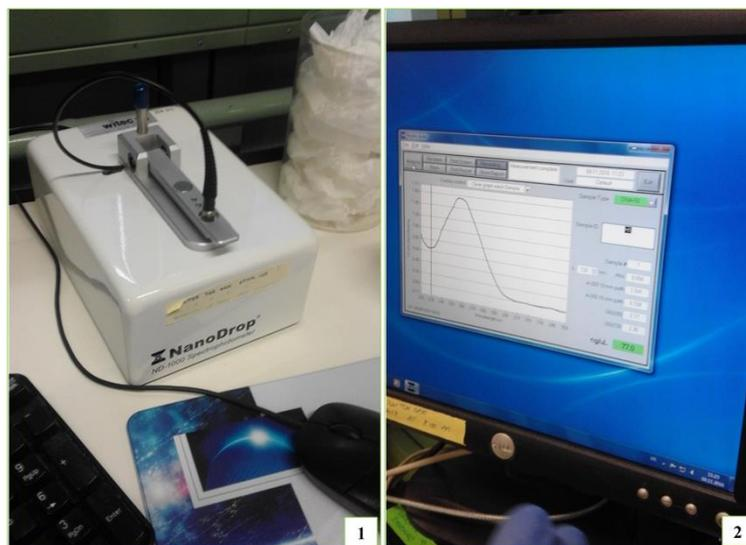
Planche 3: Etape C : 1. Spectrophotomètre Nanodrop. 2. Courbe de la quantité d'ADN d'un échantillon.
