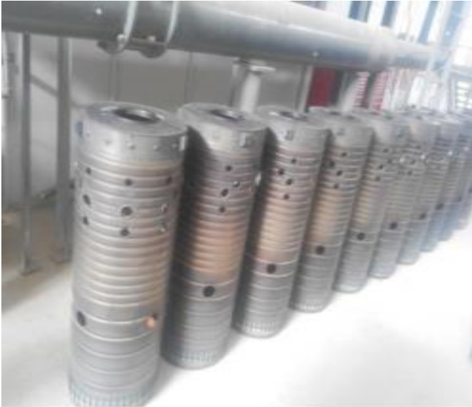
Figure II-19 : Doublures de combustion, MS9001E
