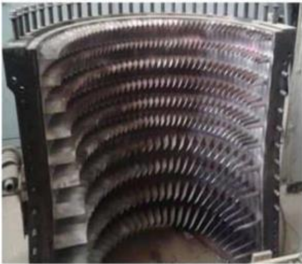
stator du compresseur axial
