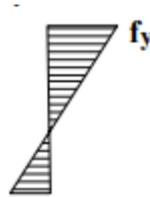
Figure 8: Diagramme des contraintes de flexion dans une section de classe 3.
