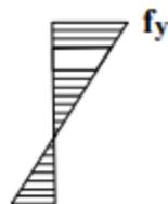
Figure 9: Diagramme des contraintes de flexion dans une section de classe 4.
