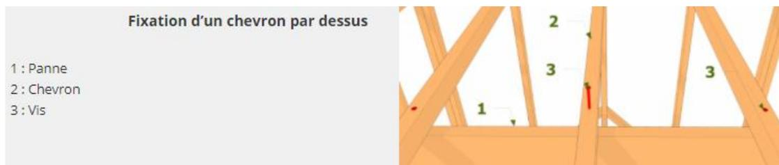
**Figure207**: fixation d'un chevron par-dessus source : <https://constructionbois.bilp.fr/guide-charpente/types/toiture-monopente/montage-charpente>
