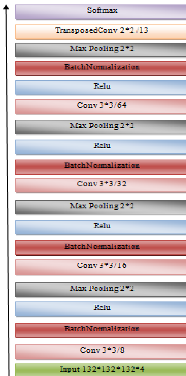
Figure III.6 : Architecture du troisième CNN formé.
