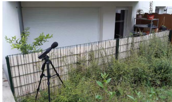
Figure 3-13 : relevé les bruits d'équipements émis vers le voisinage
