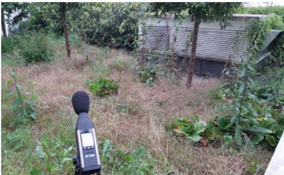
Figure 3-13 : relevé les bruits d'équipements émis vers le voisinage
