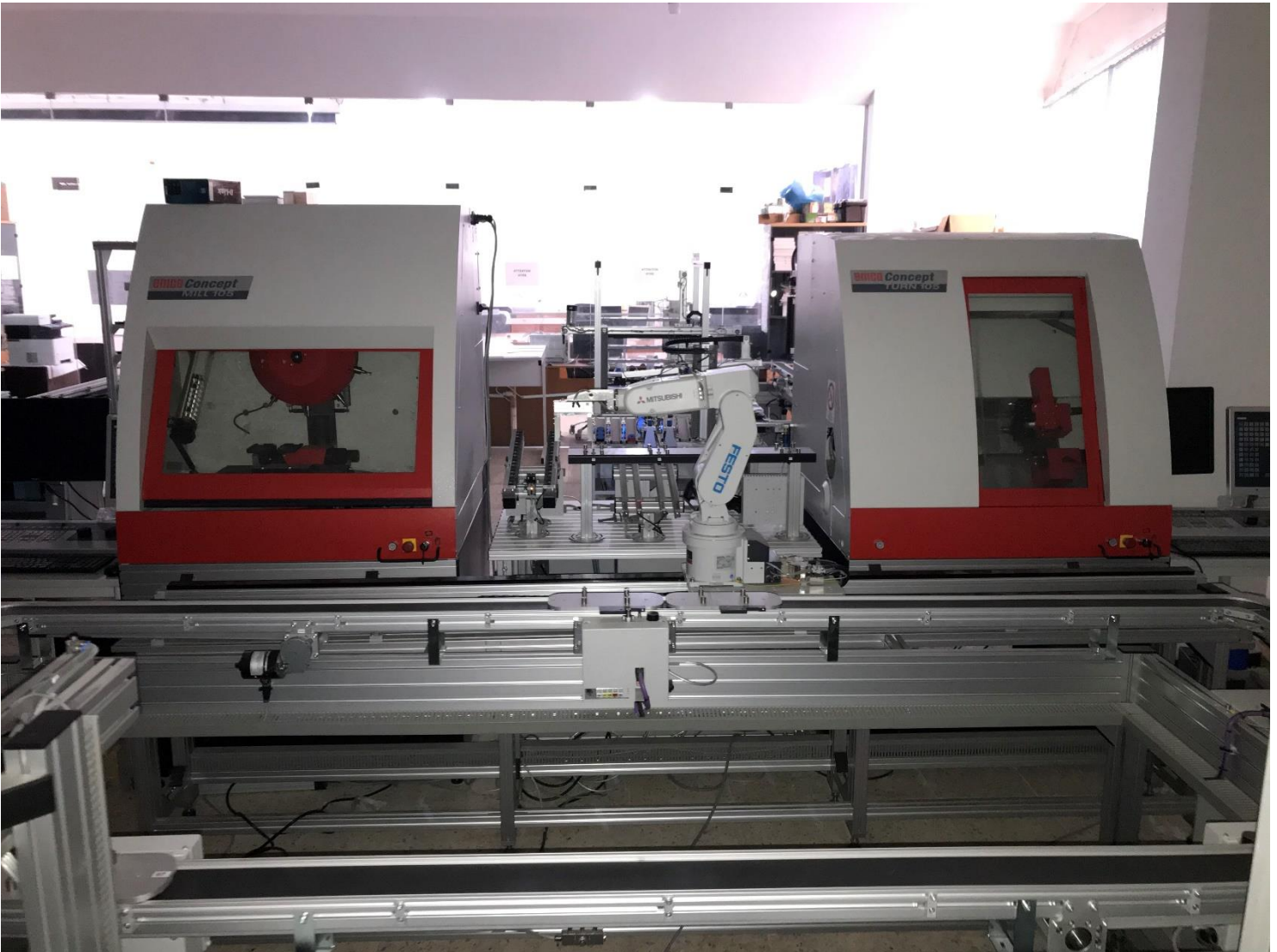
Figure 2. 1 La cellule de fabrication flexible du laboratoire MELT
