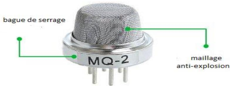
La structure en forme d'étoile du capteur est constituée d'un élément de détection connecté à six pattes de raccordement (H, A et B) à l'aide de fils Platinum [17].
