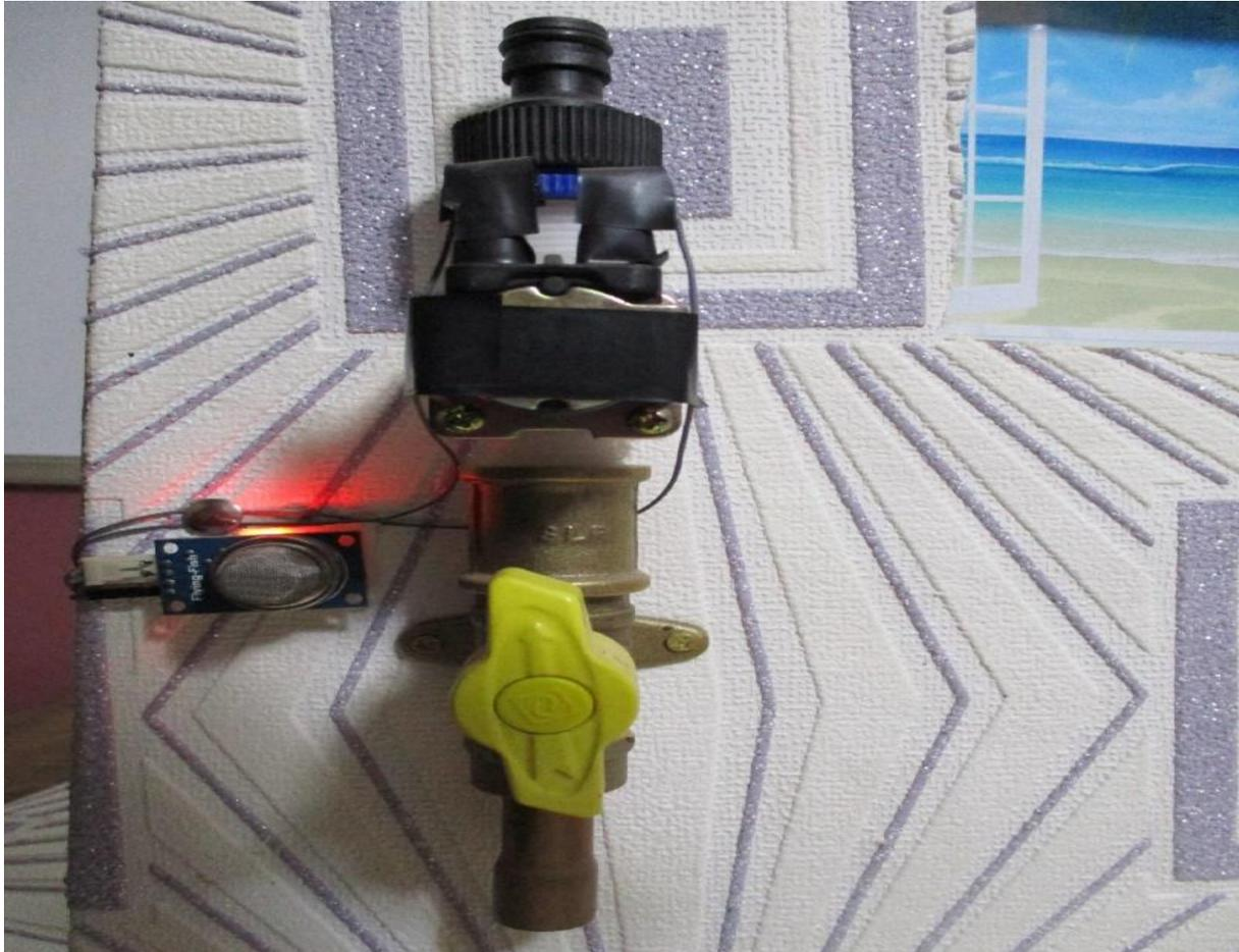
**Figure III.12 :** Bloc d'action automatique "électrovanne".
