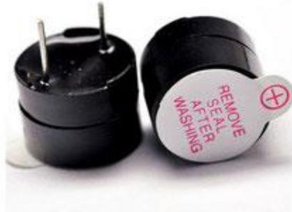
**Figure II.18 :** Buzzer piézo-électrique [21].
