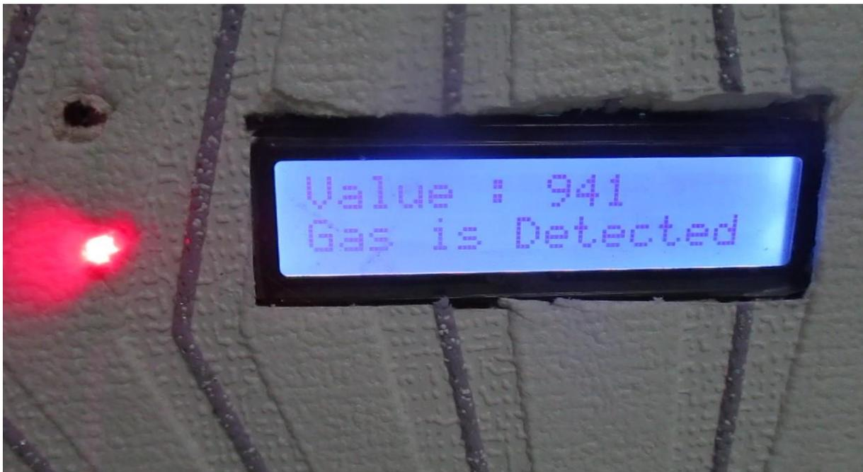
**Figure III.11** : Détection de la présence de gaz.
