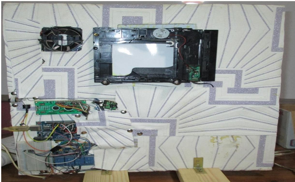
Figure III.16 : Prototype de détection de gaz "la face arrière".
