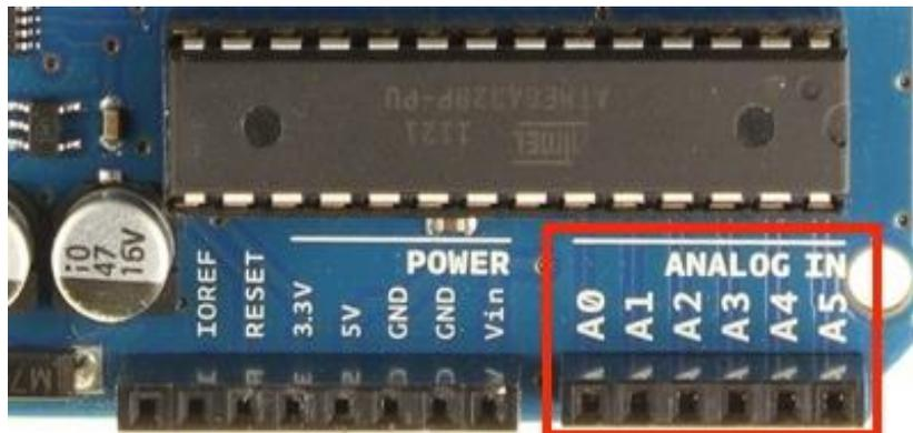
**Figure II.5 :** Broches d'entrées Analogiques [16].
