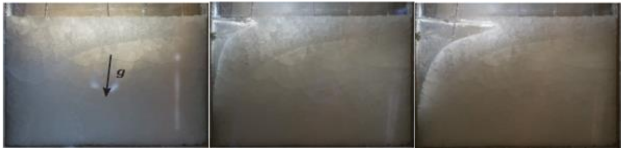
Fig 2. 16. Photos de l'évolution du front de fusion pour E2 avec T_h=331^\circ\text{C} et T_c= 290^\circ\text{C}
