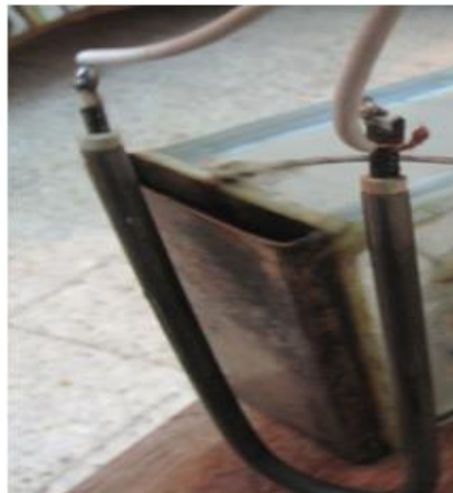
Fig 3. 10. Résistance électrique et son emplacement à l'intérieur des tôles en cuivre
