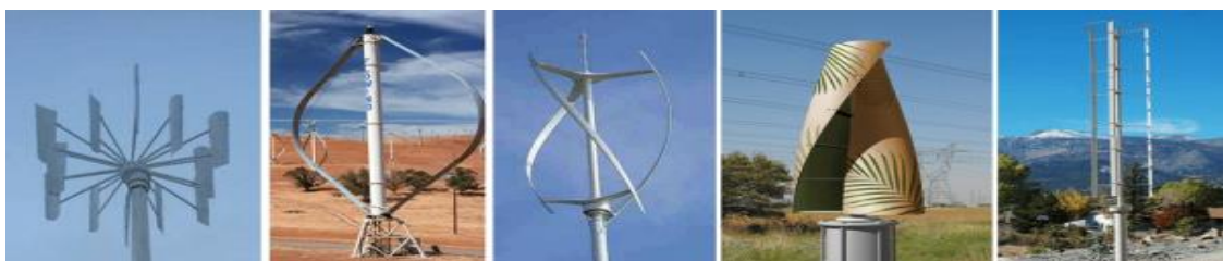
Figure II.6 : Les éoliennes à axe vertical [95].
