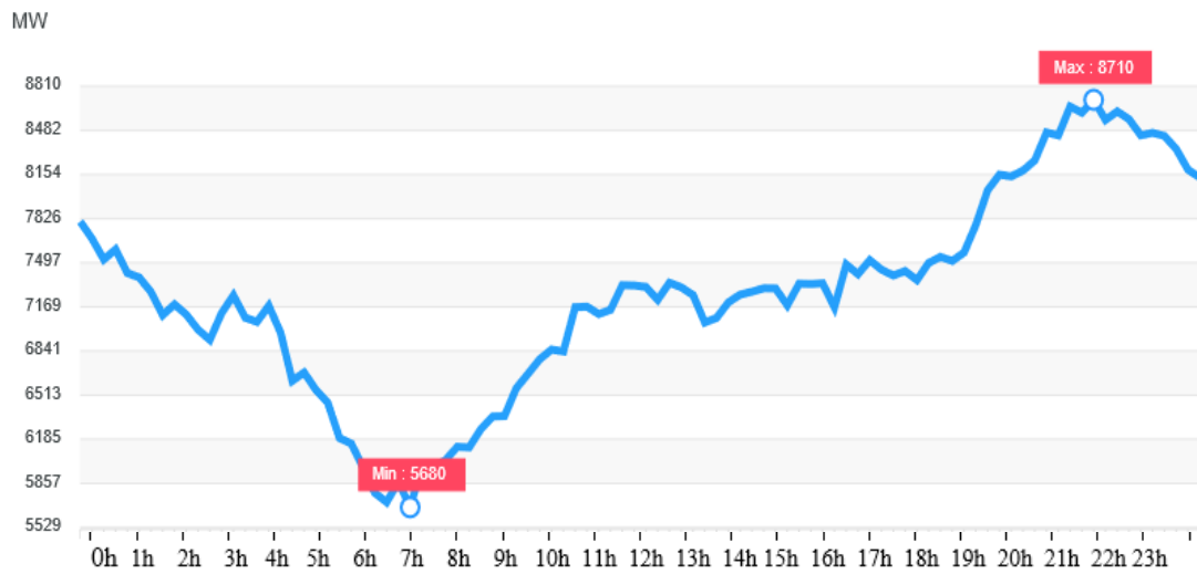
Figure 2-10 : Courbe de charge durant un jour de weekend du mois de mai
