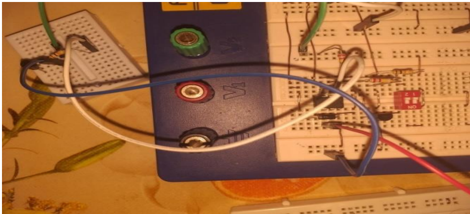
Figure -3.6- Le circuit de la comparaison des températures réalisé sous plaque d'essai
