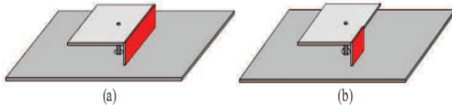
Figure 3.4 : PIFA avec court circuit : (a) : plan,(b) : languette.
