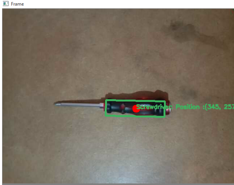
FIGURE 4.11 – Résultat de détection en temps réel avec notre modèle développé, la sortie représente la position et l'orientation de prise et aussi l'ouverture de la pince.
