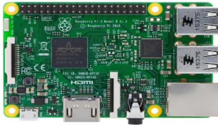
FIGURE 3.9 – Raspberry Pi 3 modèle B 1G de RAM
