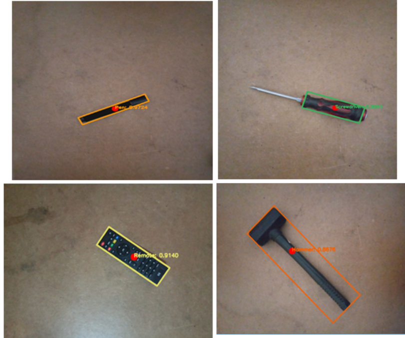
FIGURE 4.8 – Résultats de détection d'objet avec YOLOv3 et la région d'intérêt pour 4 catégories.
