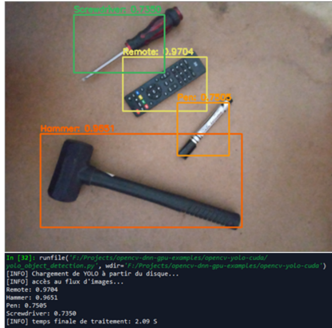
FIGURE 4.5 – Résultat de détection d’objet avec YOLOv3 sur PC Dell avec Intel I5 3Go
