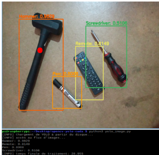
FIGURE 4.6 – Détection d’objet avec YOLOv3 sur un Raspberry Pi 3 Modèle B 1Go
