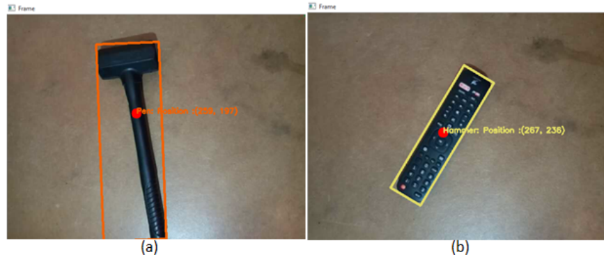
FIGURE 4.9 – Mauvais exemple de détection d’objet avec notre modèle, du fait que la région est bien détectée mais la catégorie n’est pas juste.
