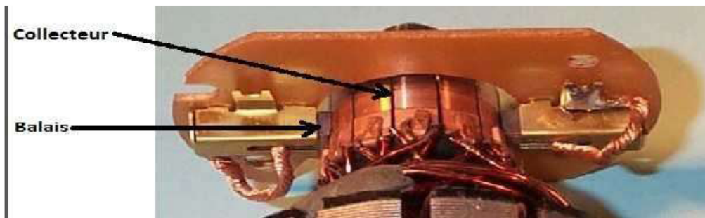
FIGURE 1.11 – collecteur et balais d'une machine à courant continu-
