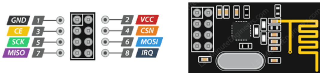
Figure 14:les différents composants du module NRF24L01
