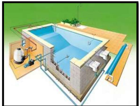
Figure 92:Schémas de système filtration pour piscine
