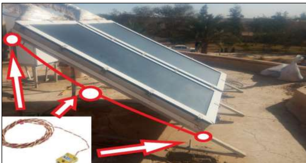
FigIII.8 Position des thermocouples dans l'insolateur (avec et sans chicanes)
