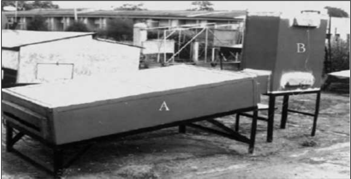
FigI.12 Systèmes de chauffage de l'air passif à énergie solaire pour le séchage. Enibe (2002)
