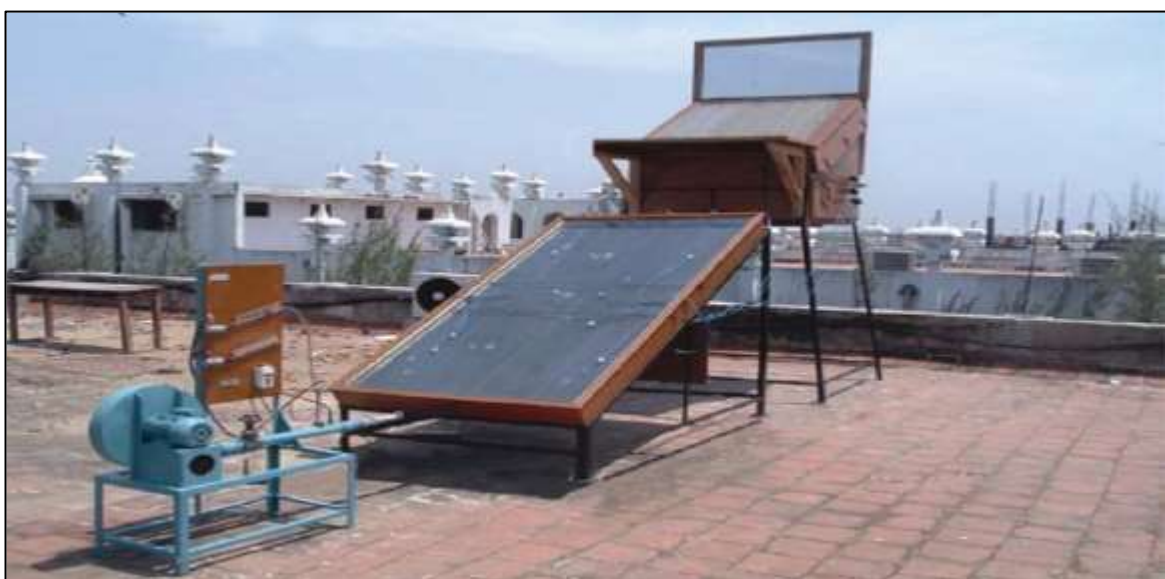
FigI.16 Miroir réfléchissant pour améliorer la régénération du dessiccant et testée pour sécher le petit pois et ananas
