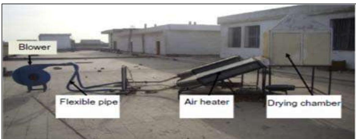
FigI.19 Séchoir solaire à convection forcée indirecte à la menthe sèche et au thymus S.M. Shalaby et al.2013
