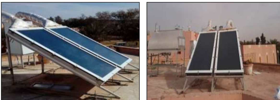
FigIII.4 le prototype utilise pour le séchage de la carotte et la menthe Celui de gauche est sans (chicanes) et celui de droite avec (chicanes)
