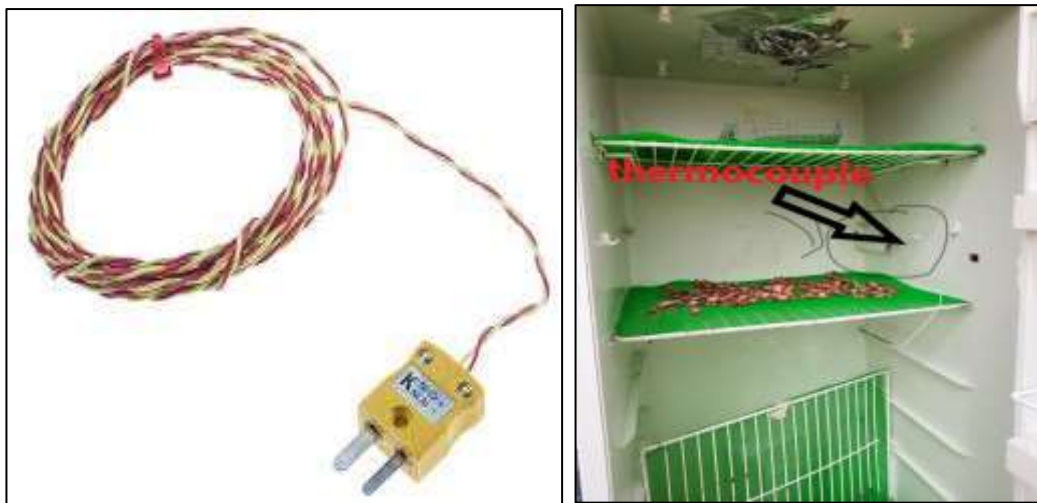
FigIII.7 Position des thermocouples dans l'armoire de séchage (Frigo)
