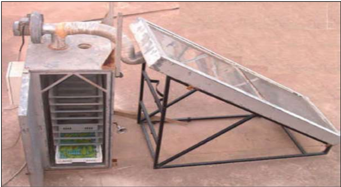
FigI.17 Séchoir solaire à convection forcée indirecte. Mohamed et al. (2008)
