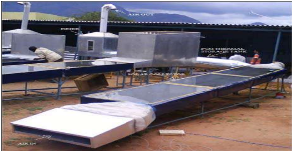
FigI.18 Un système de stockage thermique à base de matériaux de changement de phase, pour chauffer l'air utilisé dans un séchoir (Velraj et al., 2013).
