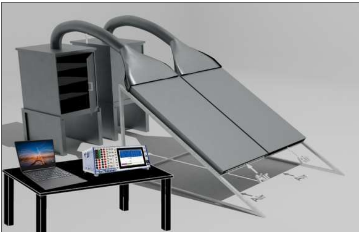
FigIII.6 Dessine technique de prototype *S* de séchoirs solaires de type indirect expérimentés
