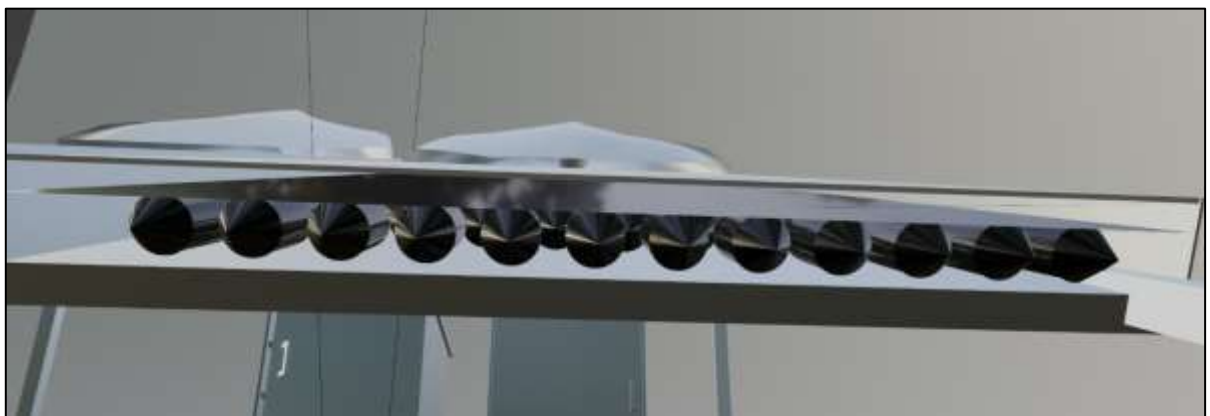
FigIV.6 L'insolateur plan à air avec des canettes
