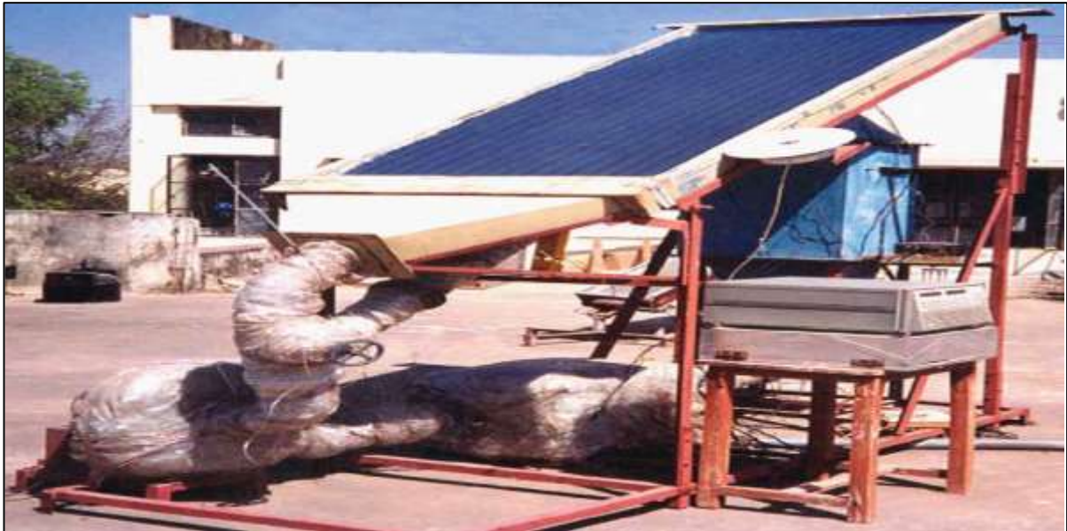
FigI.14 Séchoirs à convection avec recirculation d'air pour étudier l'effet du débit d'air. Sarsavadia (2007)
