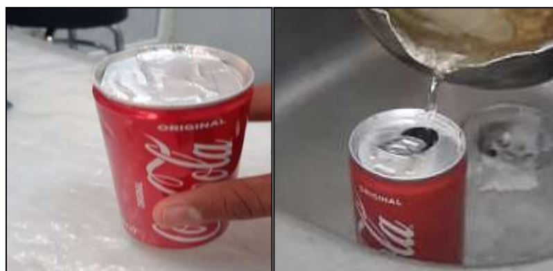
FigIII.26 : Matériau préparé pour le stockage de l'énergie thermique ( \text{CaCl}_2, 4\text{H}_2\text{O} ) versé dans les cannettes
