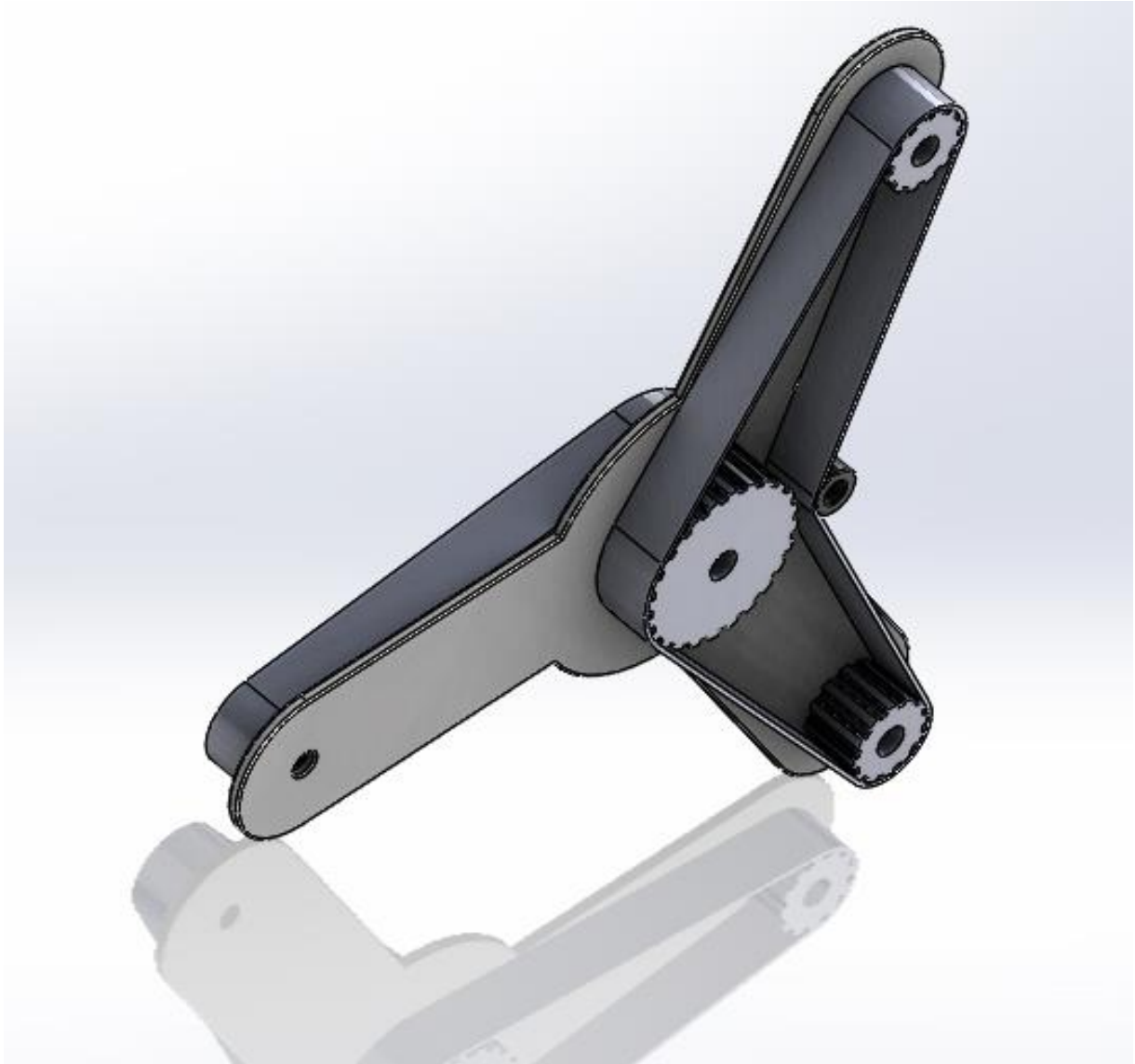
Figure V.13 : deuxième modèle de montage le système trois roues en étoiles.
