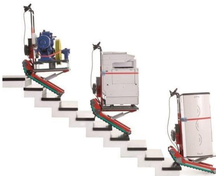
Figure II.16 : Le robot Domino transporter les poids lourds.
