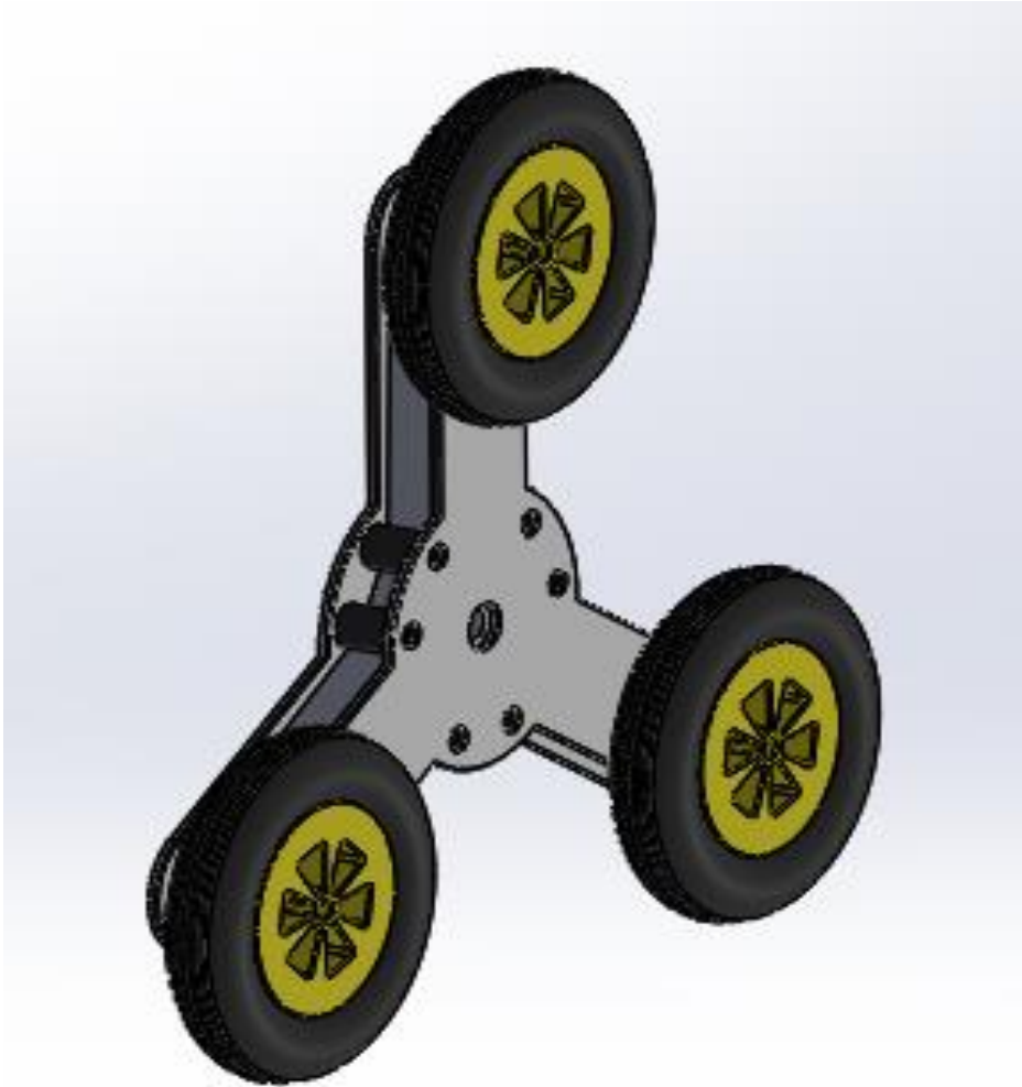
Figure V.15 : Modélisation 3D de système trois roues en étoile.
