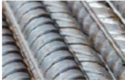
Figure I-5 : Fer à haute adhérence.
