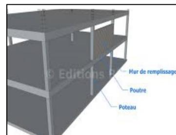
**Figure C32** : poteaux poutre
