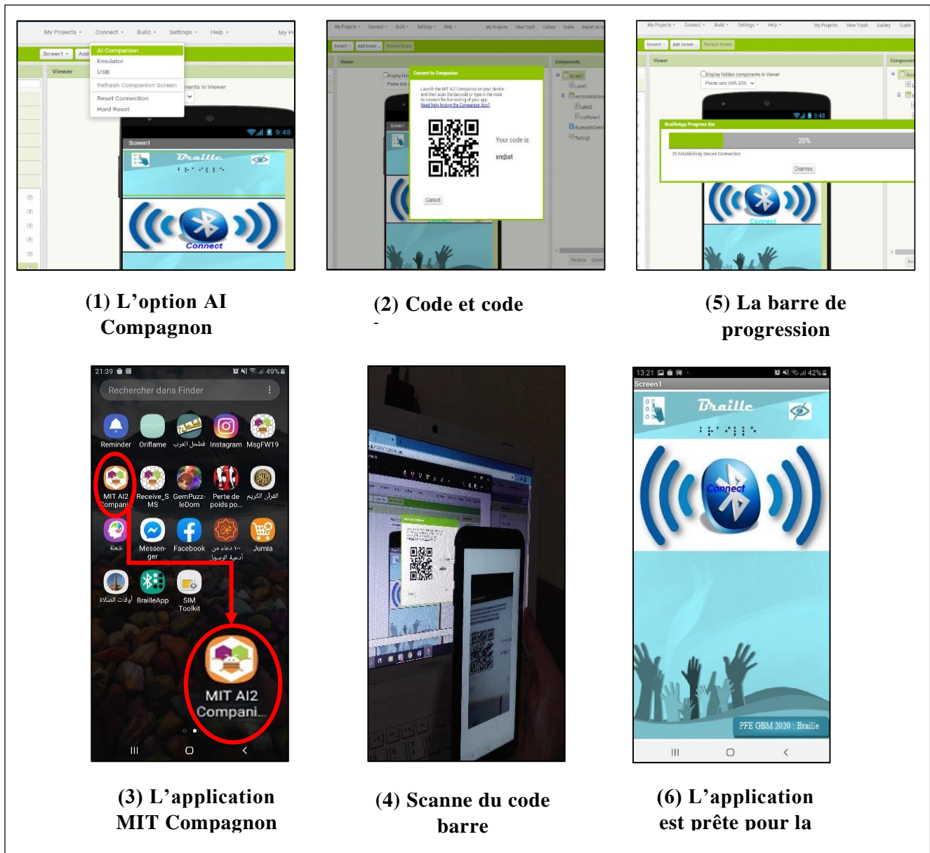
Fig.III. 9 Etapes pour tester et installer l'application "BrailleApp"
