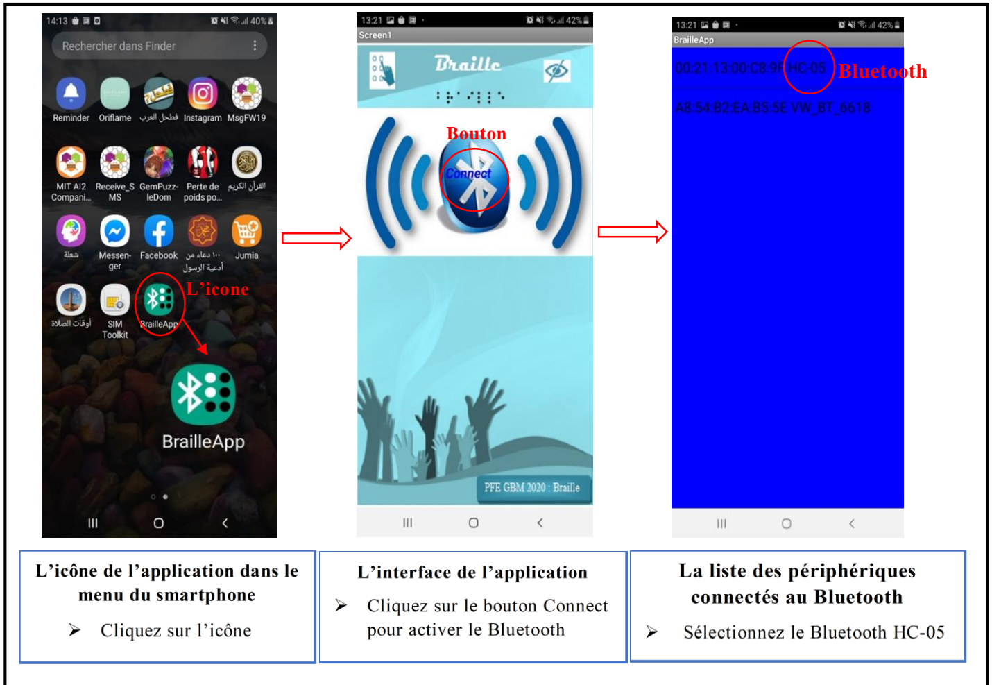
Fig.III. 11 Connexion Bluetooth entre smartphone et module HC-05
