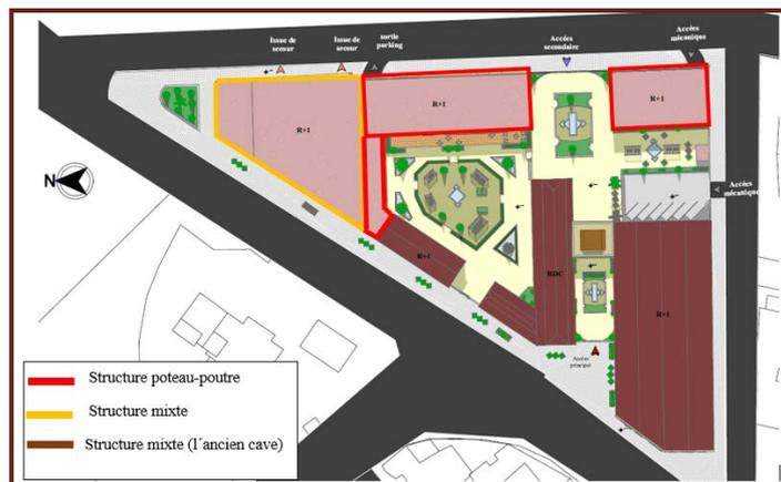
Figure 67: Système structurel de notre projet<sup>289</sup>.
