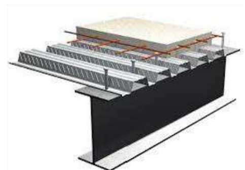
Figure 103. Les éléments principaux d'un plancher collaborant
