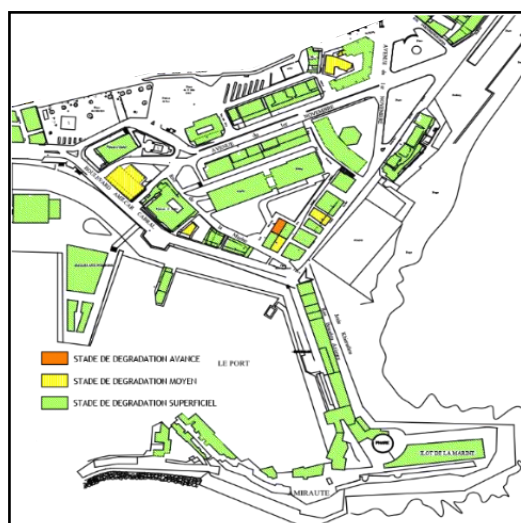
Figure 24 : Etat de conservation du cadre bâti Source : PPSMVSS
