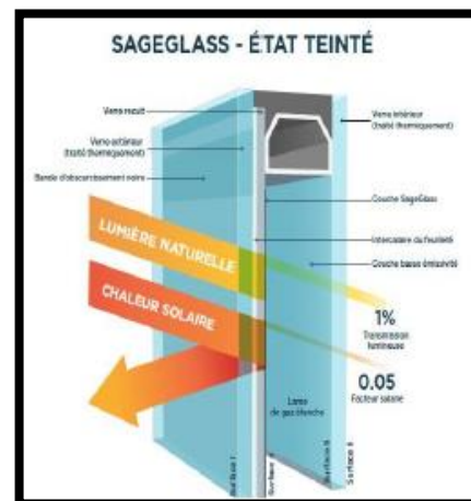
Figure 212 : Configuration d'un double vitrage electrochrome
