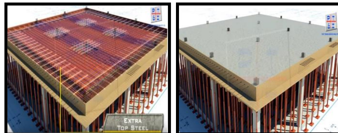
Figure 180 : bétonnage de la dalle 83 Source : https://www.youtube.com/watch?v=mfZo_Hv
