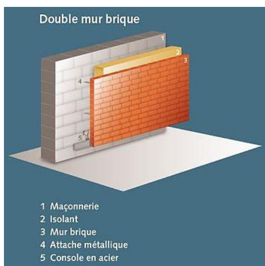
Figure 274 : Schéma de mur en brique creuses Source : https://fr.wikipedia.org/wiki/Mur_creux
