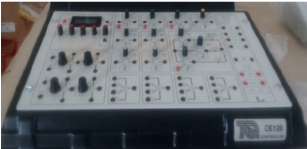
FIGURE 1.5 – Photo du régulateur CE120, disponible au niveau du laboratoire d'automatique pédagogique.
