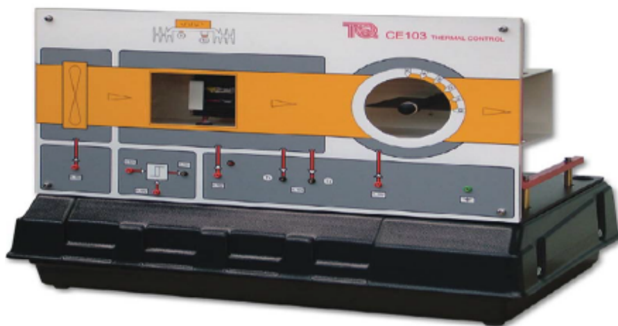
FIGURE 1.1 – Photo du banc de régulation thermique CE103, disponible au niveau du laboratoire d'automatique pédagogique
