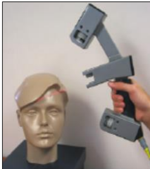
Photo 5: Un scanner laser à repérage électromagnétique. Source FUCHS 121
