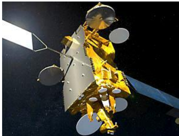
Figure I.6 : Exemple des protections thermiques des antennes spatiales (Satellite de télécommunication Yah Sat1B ) [28].
