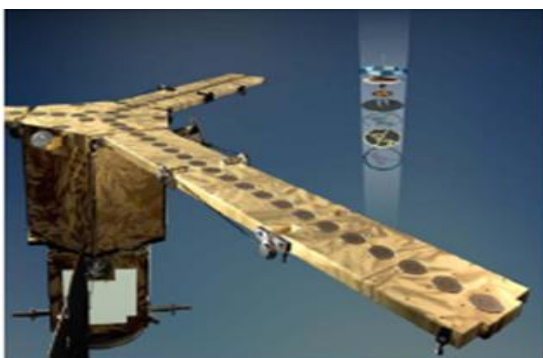
Figure I.20 : Antennes LEO : radar à ouverture synthétique (a) Antenne SMOS de la bande X [28] et (b) Antenne SIR-C dans l'étage de Configuration de laboratoire [13].
