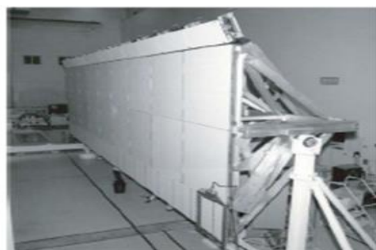
Figure I.20 : Antennes LEO : radar à ouverture synthétique (a) Antenne SMOS de la bande X [28] et (b) Antenne SIR-C dans l'étage de Configuration de laboratoire [13].
