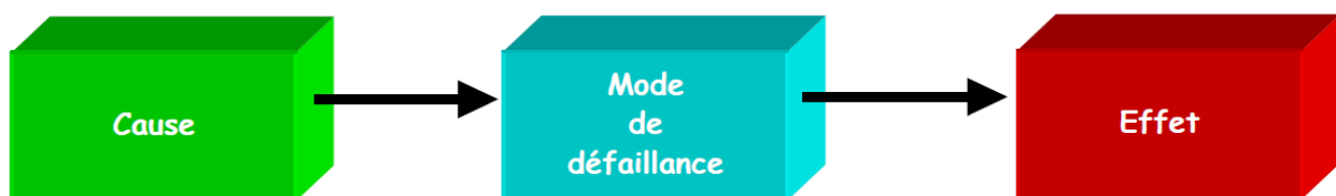
Figure II.11 : Méthode d'analyse de l'AMDEC [40].
